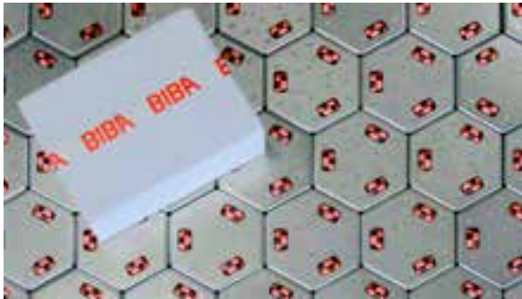
Detailansicht der Förderfläche. (Foto: David Schumacher) | Detailed view of the conveying surface. (Image: David Schumacher)
