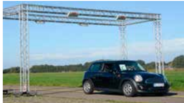
Fahrt eines PKW durch die Testinstallation zum Test der Leistungsfähigkeit der RFID-Kennzeichen. (Foto: Marco Lewandowski) | Vehicle passing the test installation for analyzing the performance of RFID tags for vehicle identification. (Image: Marco Lewandowski)
