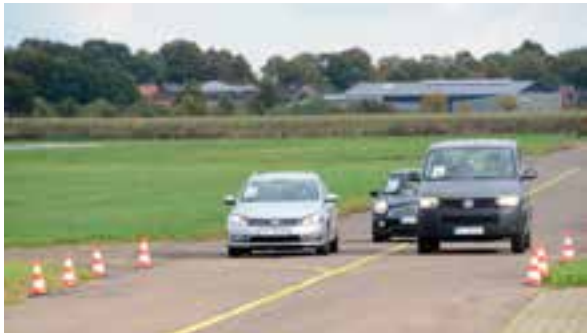
Verkehrsszenario mit verschiedenen Fahrzeugmodellen zur Überprüfung der Beeinflussung der RFID-Kennzeichen im Straßenverkehr. (Foto: Marco Lewandowski) | Traffic scenario with different types of vehicles to analyze the influence of traffic on RFID tags for vehicle identification. (Image: Marco Lewandowski)
