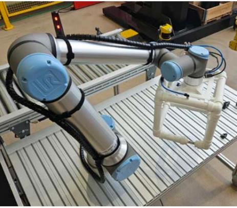
In diesem Projekt wurde ein intelligenter modularer Endeffektor-Bauteil-Schutz für die sichere, intuitive Mensch-Roboter-Zusammenarbeit entwickelt. Ein am Endeffektor montierter Schutzkokon umschließt sowohl den Endeffektor als auch das Bauteil. Durch teilweise gedruckte Sensorik und Methoden der künstlichen Intelligenz erkennt das System frühzeitig Menschen im Umfeld und Berührungen, sodass das Roboterverhalten präventiv angepasst werden kann.
