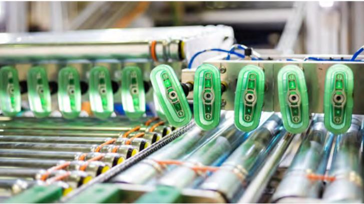
Vakuum-Greifer mit integriertem Fördersystem. (Foto: Jan Meier) | Vacuum-based gripping shovel with integrated conveyor system. (Image: Jan Meier)
