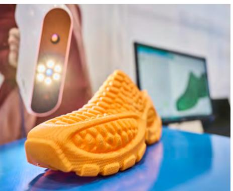
Der 3D-Druck bietet eine neue Möglichkeit der individualisierten Schuhproduktion, wobei die Herstellung von Einzelstücken hohe Anforderungen an eine automatisierte Qualitätskontrolle stellt. Durch den intelligenten Abgleich der 3D-gedruckten Schuhe mit den jeweiligen Druckdateien werden Position und Art der Fehlstellen automatisch ermittelt. Basierend auf diesen Erkenntnissen werden zukünftige Drucke angepasst und so auftretende Fehler reduziert.
