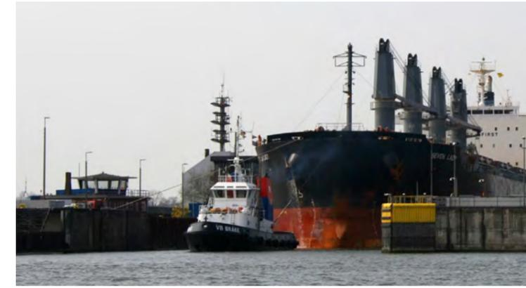
Ein Massengutfrachter wird mithilfe von zwei Schleppern durch die Schleuse in den tideunabhängigen Hafen begleitet. (Bild: Arne Schuldt) | A bulk carrier is escorted through the lock into the tide independent harbour with the help of two tugs. (Image: Arne Schuldt)
