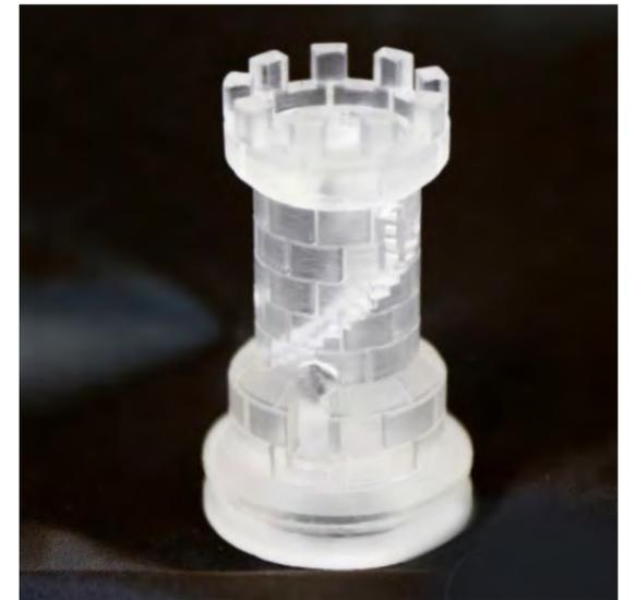
Einer der ersten 3D-Drucke aus der Stereolithographie-Anlage am BIBA. Der filigrane Schachtturm mit Tür und Wendeltreppe ist nur wenige Zentimeter hoch. (Bild: 3FAKTUR) | One of the first 3D prints from the stereolithography system at BIBA. The filigree shaft tower with door and spiral staircase is only a few centimetres high. (Image: 3FAKTUR)
