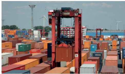
Links: Van-Carrier für den horizontalen Transport von Containern | Oben: Containerlager und Van-Carrier im Terminalbetrieb, Quellen: Sabine Nollmann
