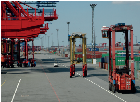
Links: Van-Carrier für den horizontalen Transport von Containern | Oben: Containerlager und Van-Carrier im Terminalbetrieb, Quellen: Sabine Nollmann
