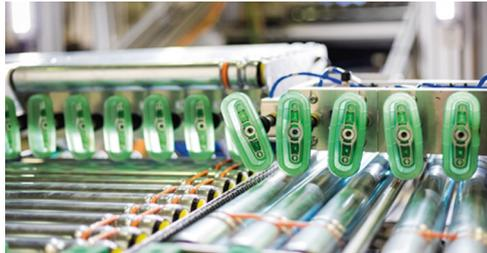
Links: IRiS-Container-Entladeroboter, Quelle: BIBA | Oben: Vakuumbasiertes Greifsystem mit integrierter Fördertechnik, Foto: Jan Meier
