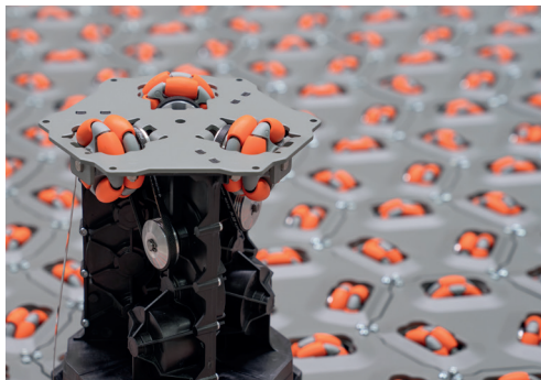
Links: Einzelne Zelle des celluveyors im ausgebauten Zustand | Oben: Eingesetzter celluveyor beim Sortieren von Paketen | Quellen: cellumation GmbH
