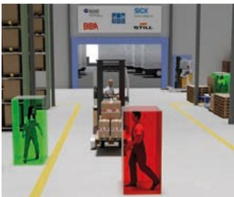
Assistenzsystem schafft mehr Sicherheit mithilfe von 2D- und 3D-Bildverarbeitung. (Grafik: BIBA) | Assistance system creating increased safety using 2D and 3D image processing. (Image: BIBA)
