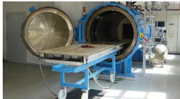
In einem Autoklav müssen die Faserverbundbauteile bei Temperaturen bis 200°C und Drücken bis 8 bar über Stunden aushärten. (Foto: Haindl Kunststoffverarbeitung) | In an autoclave, the fibre composite components cure for hours at temperatures up to 200°C and pressures up to 8 bar. (Image: Haindl)
