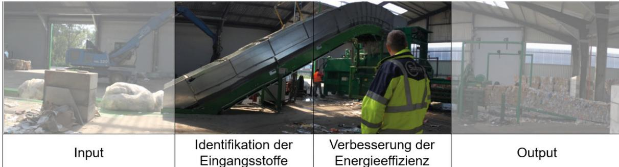
Die Material- und Volumenstromerkennung ist einer der in KiPro untersuchten Prozesse. Über die Fusion unterschiedlicher Sensordaten und mithilfe von Deep Learning wird die Materialzusammensetzung analysiert. (Foto/Grafik: André Decker) | Material and volume flow detection is one of the processes examined in KiPro. The material composition is analysed using the fusion of different sensor data and with the aid of deep learning. (Image: André Decker)
