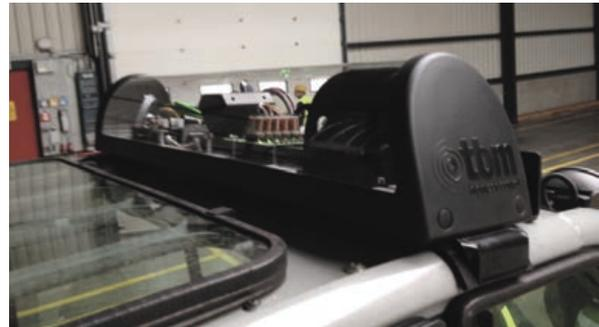
Die Sensorik am Fahrzeug ist über eine Schnittstelle des Projektpartners tbm hightech control mit der Fahrzeugsteuerung verbunden. (Foto: Jens Ehm) | Sensors on top of the vehicle have direct access to the vehicle control system via a proprietary interface of the project partner tbm hightech control. (Image: Jens Ehm)
