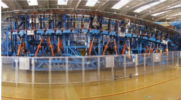
Testaufbau für Hochauftriebssystem am Airbus-Standort Bremen. (Foto: AIRBUS) | Test installation for a high-lift system at the Airbus site in Bremen (Image: AIRBUS)
