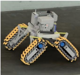
Die Übertragung der Funktionsweise von Mecanum-Rädern auf Kettenfahrantriebe soll die Bewegungsfreiheit von Baumaschinen erhöhen. (Foto: BIBA) | Transferring the functionality of Mecanum wheels to chain-driven motors will increase the freedom with which construction machines can move. (Image: BIBA)
