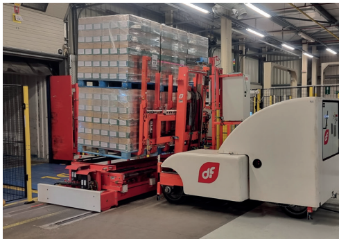
Links: Verladesystem vor einem Verladetor | Oben: Lidar Steuerungsschnittstelle, Quellen: BIBA GmbH
