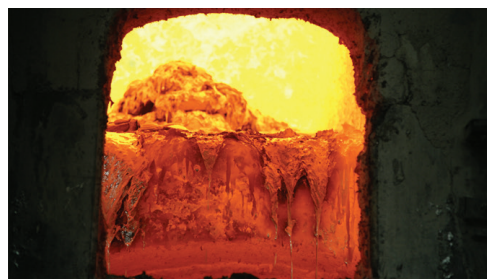
Links: Geplante Prozesssteuerung des Aluminiumschmelzofens | Oben: Sicht auf die Schmelzbrücke durch die Wartungstür, Quellen: ZPF
