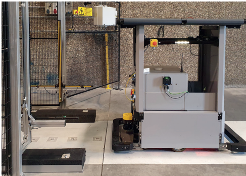
Links: Kollaborativer Sortierroboter | Oben: Im Sortierzentrum arbeiten kollaborative Fahrzeuge und Menschen Hand in Hand, Fotos: Fives
