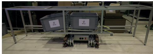
Links: Prototypisches fahrerloses Transportfahrzeug mit Mecanum-Ketten-Antrieb | Oben: FTF mit KLT-Übergabestation im Pilottest, Fotos: BIBA
