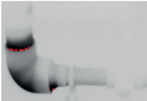
Links: Darstellung gegenüber der Umgebung kalter Abschnitte des Rohrsystems sowie erkannte Leckagen, Foto: BIBA | Oben: Beibunkung eines LNG-Bunkerschiffs, Foto: © vladsv/Fotolia.com
