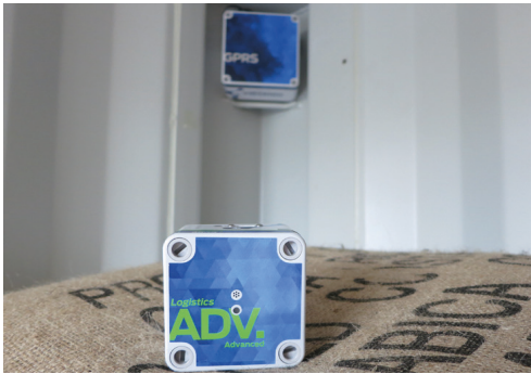
Links: Drahtloser Sensorcube (im Hintergrund GPRS-Telematik) | Oben: Webportal, Fotos: BIBA
