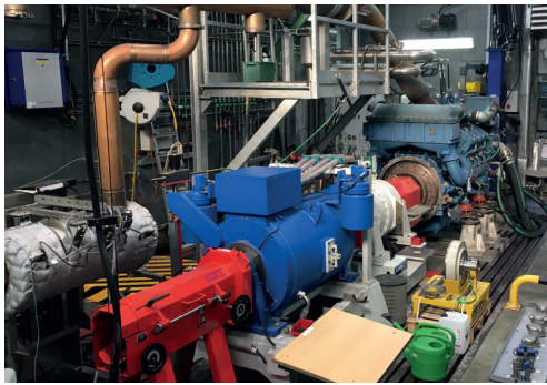
Links: Motor auf dem Prüfstand bei der DB Fahrzeuginstandhaltung im Werk Bremen | Oben: Entwickelte Toolbox zur Erfassung und Analyse von Sensordaten, Quellen: BIBA
