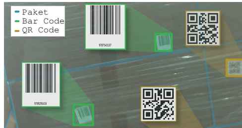
Links: Schematische Darstellung der DroneStock-Lösung | Oben: Mittel KI-basierter Objekterkennung werden einzelne Pakete (blau) erkannt und relevante Bar- und QR-codes auf den Paketen (grün und orange) registriert, Grafiken: Benjamin Staar
